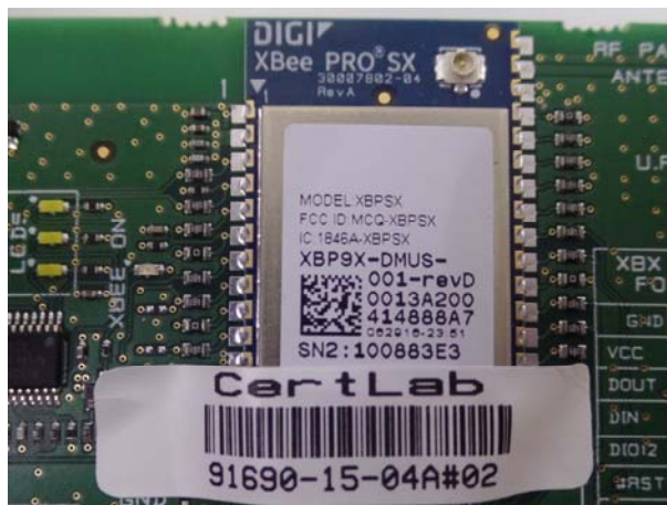
Figura 10 - Detalhe da Etiqueta do Terminal
