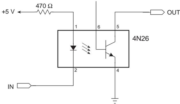
**Figure 15-3. XP8810 Optical Isolation Circuit**
