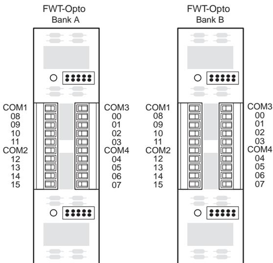
**Figure 4-8. FWT-Opto Pinouts**
