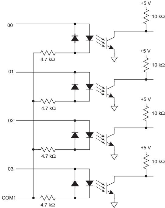
**Figure 4-9. FWT-Opto Optical Isolation Circuit**
