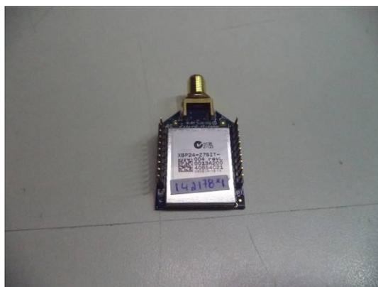
Foto 1 – Transceptor de radiação restrita modelo XBP24-Z7SIT-
